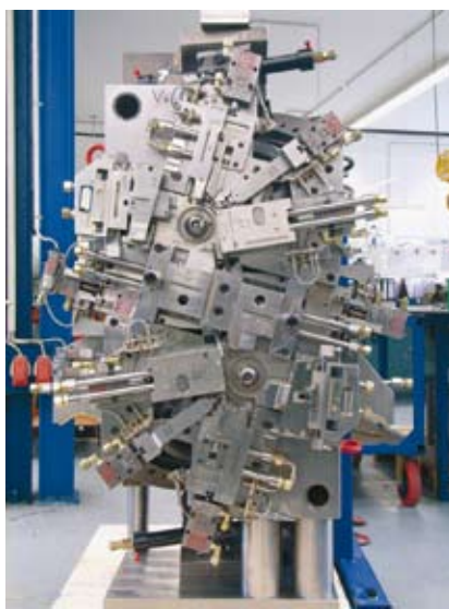
Bild 5: Konstruktivismus pur: 2-fach-Hochtemperaturwerkzeug mit 20 Schiebern zur Werkzeugentformung (Werkbilder: sk-werkzeugbau GmbH/Extretal)
