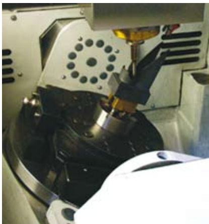
Bild 2: Die Komplettbearbeitung von Grafitelektroden auf der 5-Achs-HSC-Fräsmaschine OPS 550
