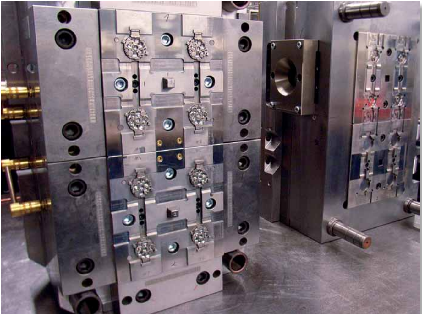
Bild 1: Spritzgusswerkzeug Regen-Licht-Sensor (Werkbild: sk-werkzeugbau GmbH, Extertal)
